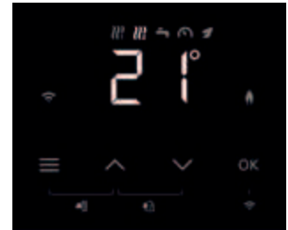
3,5-palcový 7 segmentový displej s dotykovými tlačidlami
